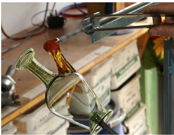
Ansetzen und Ausziehen des Henkels am Kannenkörper.
