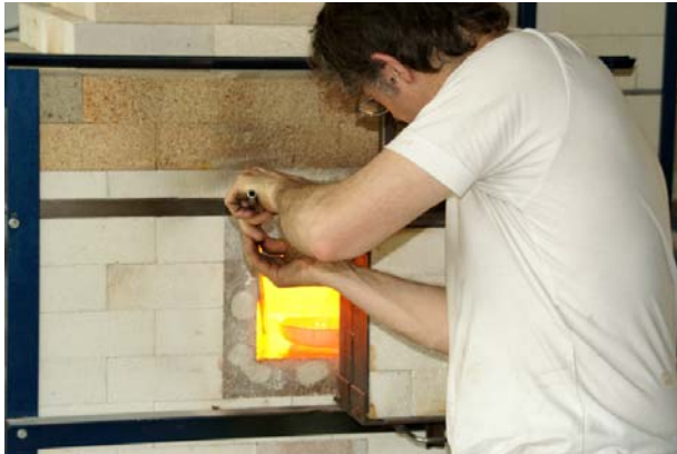
Entnehmen der Glasmasse aus dem Ofen mit den Hafengefäßen.
